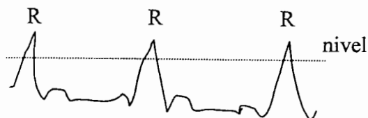
Figura 1.- Demostración de la generación de una señal de pulso a partir del ECG
