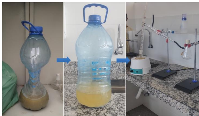
Figura 1 – Produção do álcool a partir da cana-de-açúcar sistema de destilação (Etapa 2)
